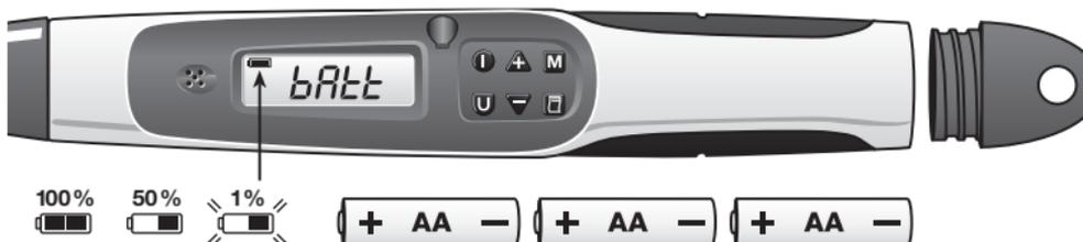
La llave dinamométrica IZO Bahco se apagará automáticamente tras permanecer inactiva durante más de dos minutos, para conservar las baterías. Si el indicador de batería del display parpadea significará que está próxima a descargarse, debiendo ser reemplazada para garantizar la precisión de la llave dinamométrica.
