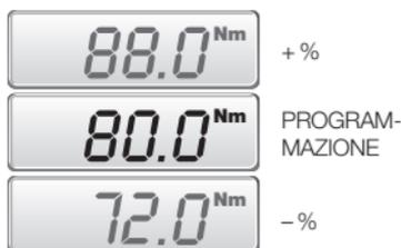
La chiave dinamometrica è programmata a 80 Nm. Se la tolleranza è regolata a  $\pm 10\%$  allora l'allarme inizierà a 72 Nm oppure a 88 Nm nel caso in cui si applichi una torsione troppo elevata.
