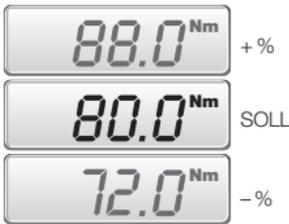
Der Drehmomentschlüssel ist auf 80 Nm voreingestellt. Ist die Toleranz auf  $\pm 10\%$  eingestellt, so wird der untere Alarm bei 72 Nm ausgelöst, der Alarm für Überschreitung des Drehmoments bei 88 Nm.
