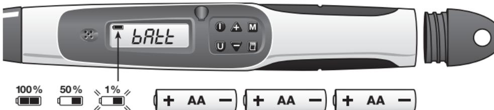
Na twee minuten ongebruikt te zijn, schakelt de BAHCO IZO-momentsleutel automatisch uit om de batterijen te sparen.
